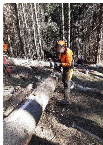
Figura 22 - Scortecciatura manuale con fresa (fonte Servizio Foreste)
