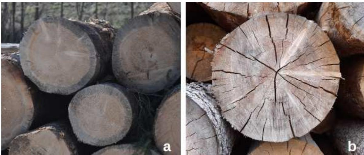
Figura 19 - Esempio di tronchi bostricati soggetti ad azzurramento (16a) o a fessurazioni (16b).
